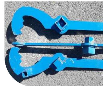
**SAROUT multifonction** conçu par les équipes hydrocurage de Lydec, d'une longueur de 50 cm et d'un poids de 1.6 kg. Cette pièce permet à l'opérateur de réaliser toutes les manœuvres relatives à l'approvisionnement en eau des citernes des hydrocureurs lors des interventions de pompage sans avoir recours à toutes les clés spéciales séparées qu'il utilisait d'habitude.
